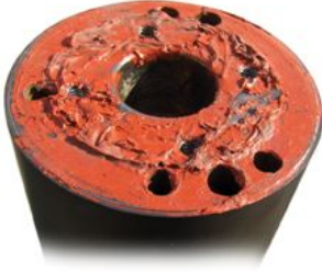
yanlış silikon uygulaması
