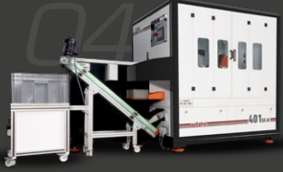
401 SF&M Manşon Taşlama Makinesi Akıllı Besleme Sistemli İki Bağımsız Taşlama Ünitesi & Çoklu Fonksiyon
